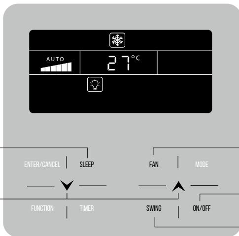
Включение и выключение функции сна.
